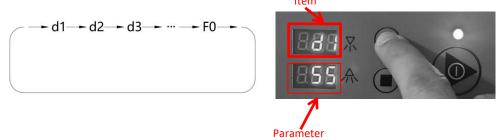
Short press Confirm Button to adjust the parameter
